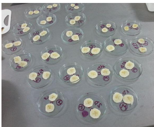
Figura 1 - Placas de petry com amostras de banana a serem secas em estufa com circulação de ar. Fonte: Acervo dos próprios autores.
