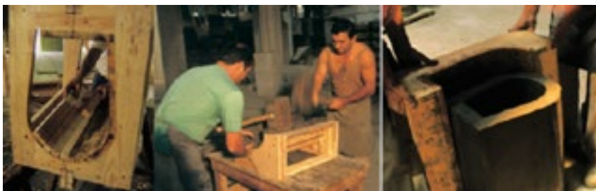
Fig. 3: Os meios de produção disponíveis consistiram numa equipe de moldadores manuais, treinados por sucessivas gerações de trabalhadores que, a partir de meados do século XIX, adaptaram a moldagem manual de peças para a produção em série de produtos em grés.
