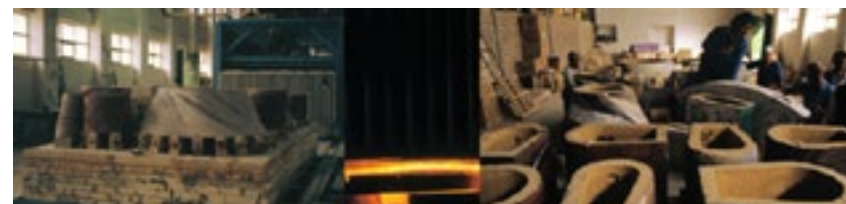
Fig. 4: O método de trabalho baseou-se num diálogo permanente entre os diferentes agentes técnicos, que permitiu a celeridade na escolha da monocozedura a 1.200 graus, sem necessidade de repetição de fornada.
