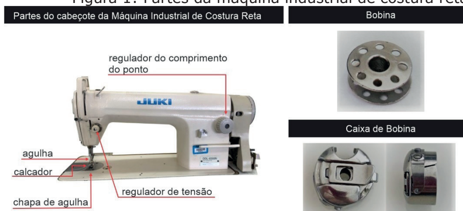
Figura 1: Partes da máquina industrial de costura reta
