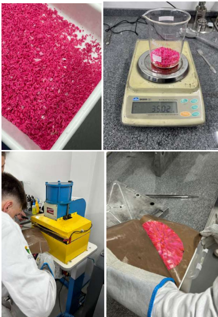
Figura 2. Fotografias do reprocessamento: Manufatura de chapas recicladas
