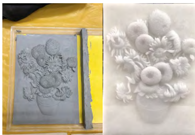
Figura 1 Processo de confecção da matriz e prancha tátil utilizada nesta pesquisa.
