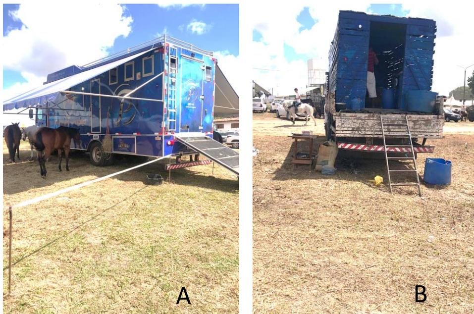
Figura 1. Veículos utilizados para transporte de equinos. Em A observa-se caminhão projetado para transporte de equinos, e em B caminhão de transporte de cargas adaptado para transporte de equinos mediante colocação de gaiola de madeira.
